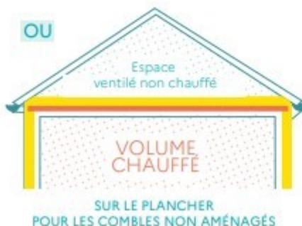
Isolant avec membrane pare-vapeur placée du côté du volume chauffé
