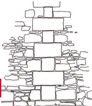
Chaîne en pierre de taille d'un mur en moellon calcaire et quelques grès
