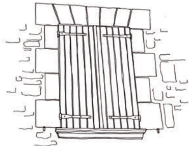
Volets en bois plein avec éléments de ferrures et encadrement en pierre de taille
