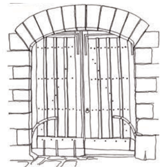
Portes cochères cintrées avec encadrement en pierre de taille
