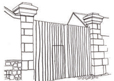
Haut portail en bois plein encadré par de hautes piles en pierre de taille
