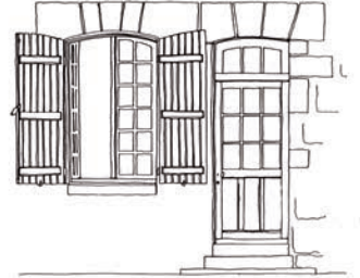
Porte d'entrée avec imposte et partie vitrée
