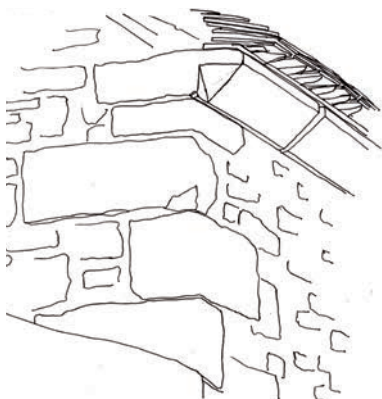
Corniche en pierre et chaînage d'angle en pierre de taille
