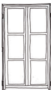
Fenêtre traditionnelle à deux vantaux ouvrant à la française, avec une division à trois carreaux
