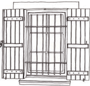
Volets en bois plein à lamelles
